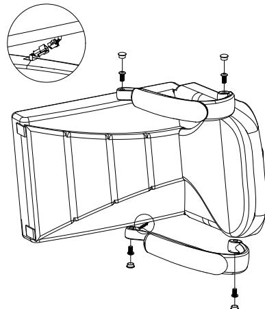
Шаг 4: После установки подлокотников, затяните 4 болта крепления сиденья и спинки, как показано на рисунке. Закрепите сиденье с основанием с помощью 4 болтов на нижней части сиденья (используйте крестовую отвертку или шуруповерт).
